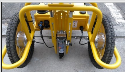
スプレー缶設置状況
