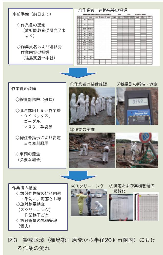
図3 警戒区域（福島第1原発から半径20km圏内）における作業の流れ
