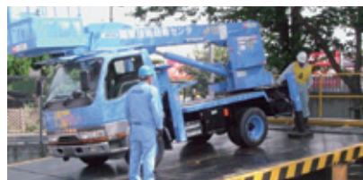
傾斜地における危険確認
