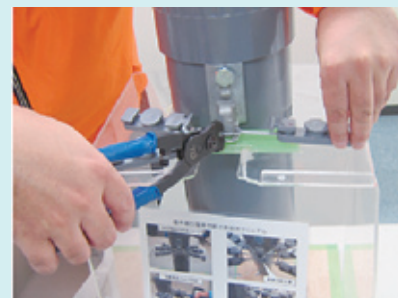
⑨ 屋外線引留具切断工具 複数の屋外線引留具が設置された環境において所定の引留具を効率良く撤去できる切断工具を体感
