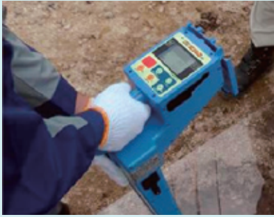
i) 埋設物探知機の操作
