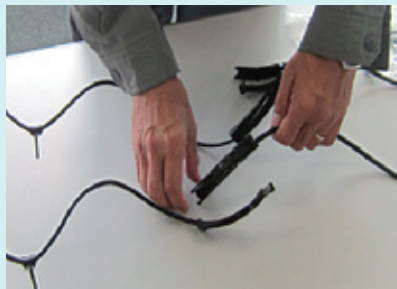
⑤ コサインカーブハンガ連結具 電柱移設等を行う際に取り付ける終端クランプの代替として開発した連結具の取付けを体感
