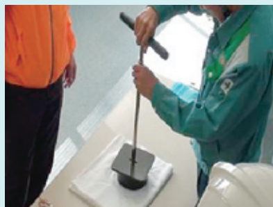
⑧ 安全装置付ハンドホール開閉鍵 ハンドホール鉄蓋の鍵穴と開閉鍵のフックが外れない安全機構付きの開閉鍵を体感
