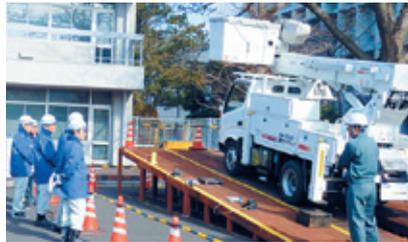
滑り落ちや、高所作業等を体験しました。バケット車の滑り落ち実演では、7度の傾斜地にバケット車を停車させ、間違った輪留め方法やアウトリガーの張出しを行い、7tもあるバケット車がいとも簡単に滑り始めるという事象を体感しました。
