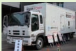
⑰移動電源車1000KVA
