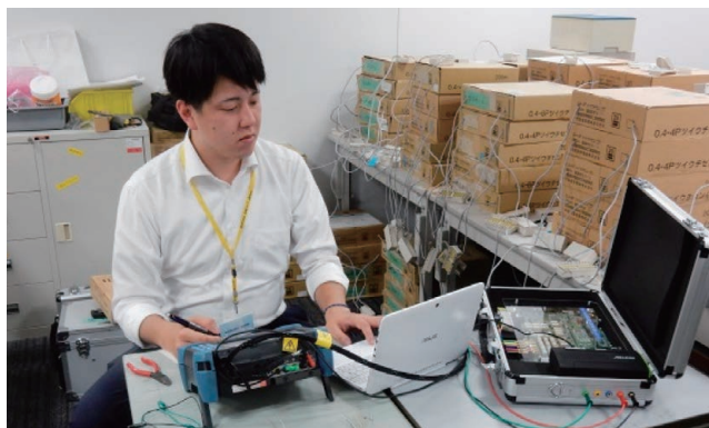
写真 メタル不良位置探索機の検証（実験室）
