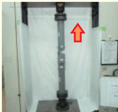
図2 引張試験状況
