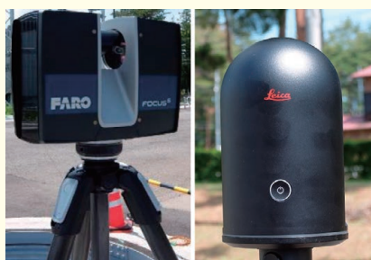
図1 固定式3Dスキャナ (左: FARO Focus S350 右: Leica BLK360)
