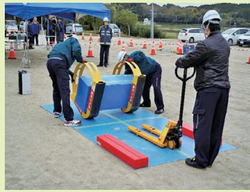
写真18 蓄電池回転治具による指挟み事故の防止実演
