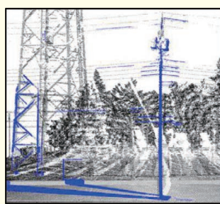
図4 点群重畳結果 (黒: MMS点群 青: 固定式点群)
