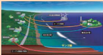
弧状推進（アースシャトル）工法の概要
