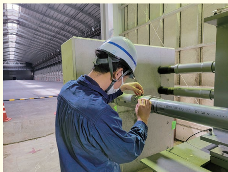
図1 加速度センサ設置状況
