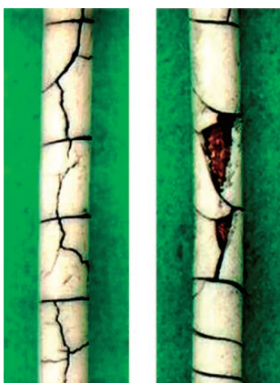
図1 心線絶縁体の劣化
