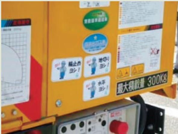
図6 バケット車への指差呼称シール貼付
