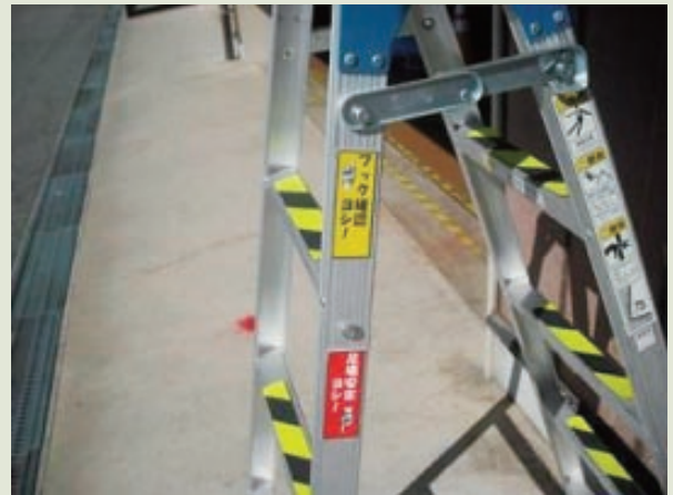
図7 脚立への指差呼称シールと滑り止めの貼付
