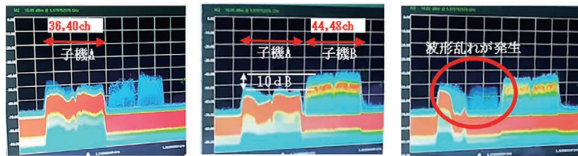
(1) 子機Aのみ通信中 (2) 子機B通信開始直後 (3) 通信開始2〜3秒後
